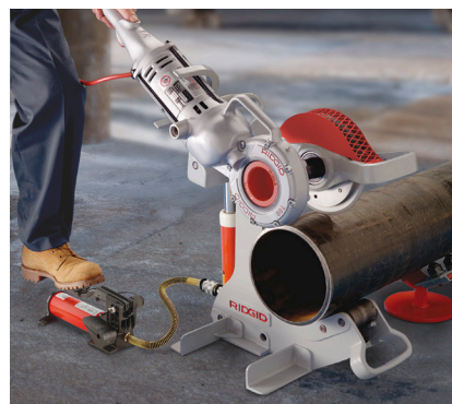
Řezák trubek - model 258 s elektrickým pohonem č. 700 použitý pro dělení trubky
